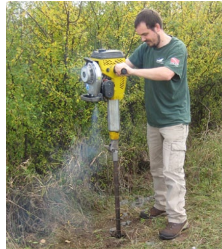
Einrichten einer Grundwasserstelle Foto: F. Krüger
