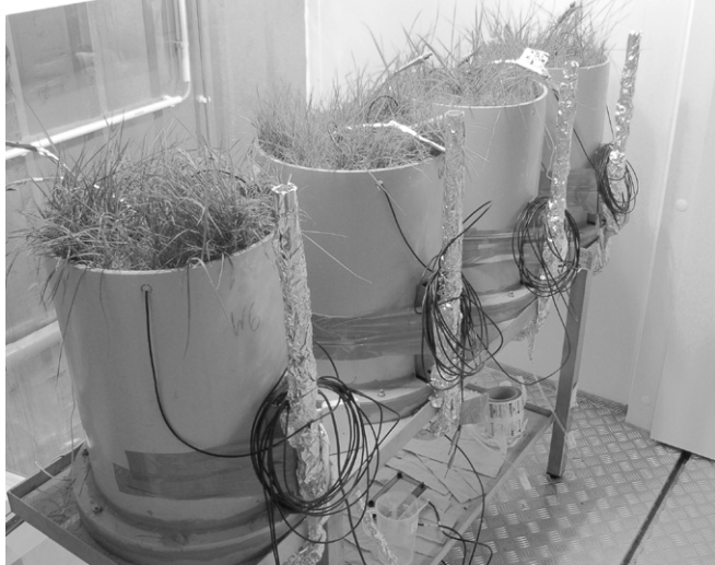
Abb. 8.6: Klimakammer mit Auenboden-Lysimetern
